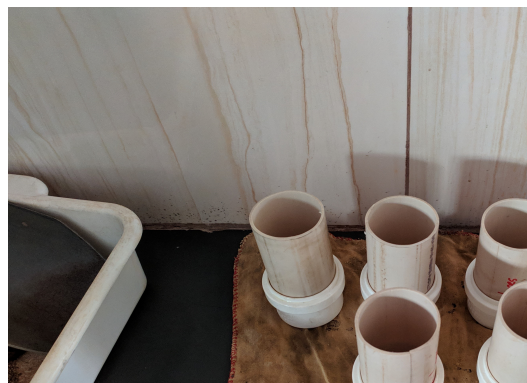
Figura 5 – Moldes dos corpos de prova
